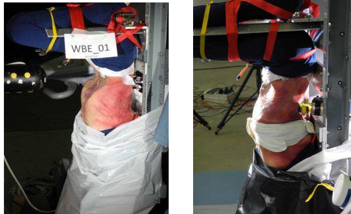
Figure 72 : Sujet mis en position avant et après la mise en place des chambres à air
