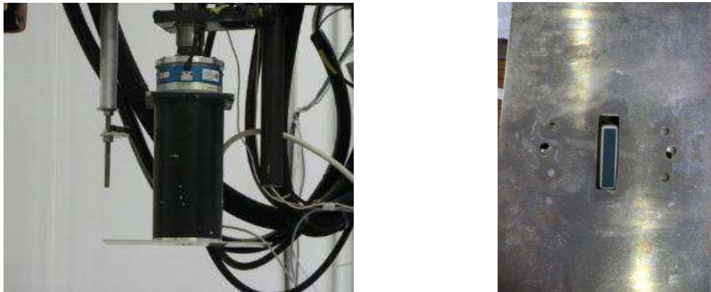
Figure 34 : Photo graphie de l'impacteur (sonde mobile perpendiculaire à la sonde fixe)
