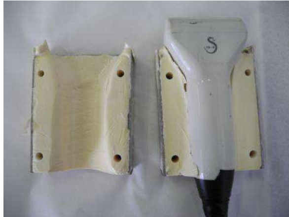
Figure 33 : Photographie du moulage de sonde en polyuréthane
