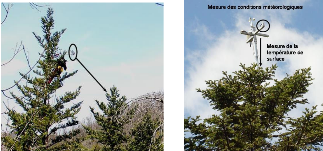
Photo 2.5 : Photographie de l'ancien (à gauche) et du nouveau (à droite) dispositif de mesure de la température de surface et des conditions météorologiques. Photographie : A. Chanzy.
