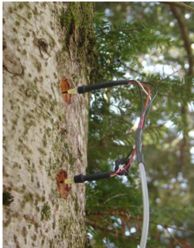
Photo 2.4 : Photographie des aiguilles servant à la mesure de densité de flux de sève avec la méthode à dissipation de chaleur.
