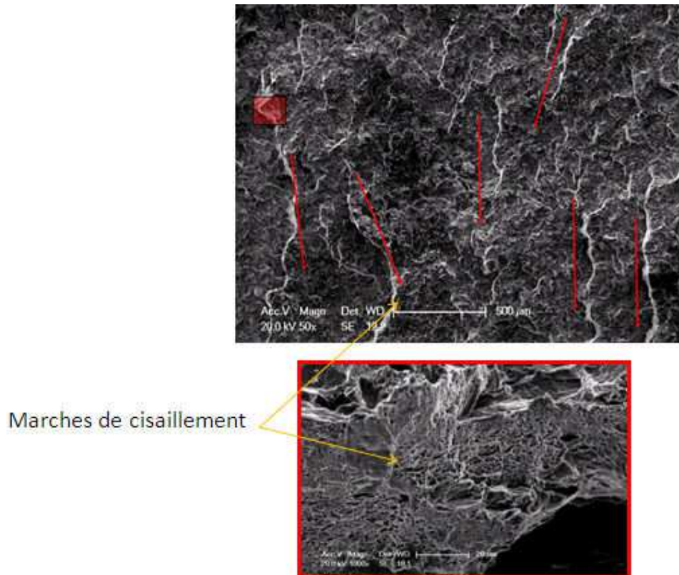
Figure 4.4.4.1.c : Fractographie de l'éprouvette 520RY-BK (-100°C, K_I = 123 \text{ MPa} \cdot \text{m}^{0.5} )
