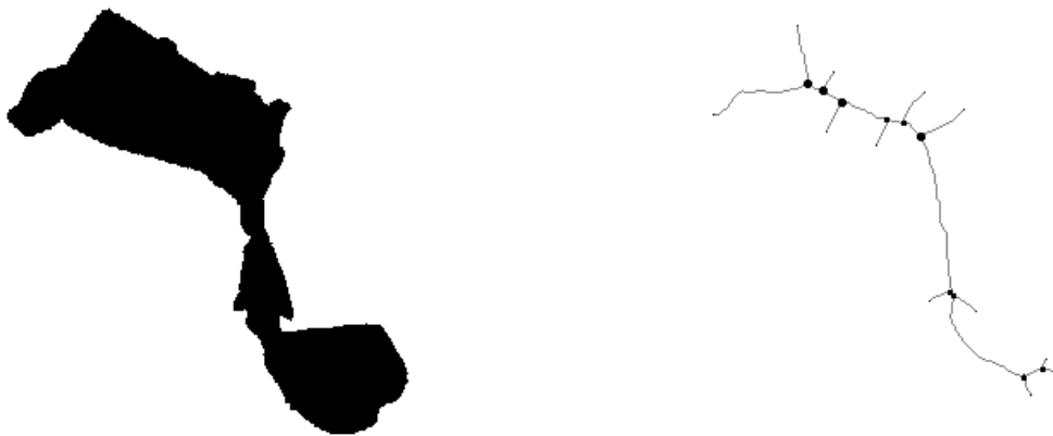
Figure 4.12 : Image d'un grain et de son squelette. Les gros points en noir sont les points nodaux, de ces points partent les branches. Le dernier point au bout des branches terminales s'appelle le point extrémité.
