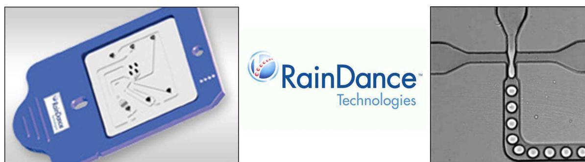
Fig. 5 : Illustration des puces microfluidiques développées par RainDance Technologies pour la formation de microgouttes dans des canaux.
