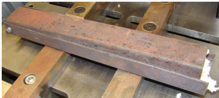
Figure III-2 : boîtier utilisé pour maintenir l'échantillon à température.
