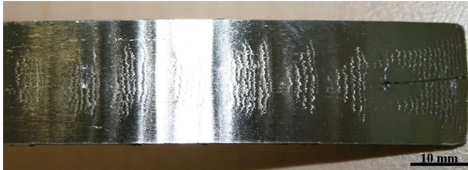
Figure III-20 : ridules apparaissant à la surface en contact avec le rouleau lent lors de laminage asymétrique.
