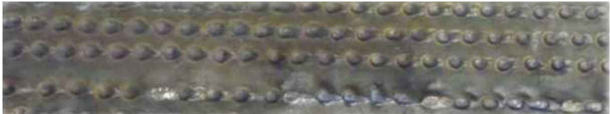
Figure 46 : Dépôt discontinu du fil dû au positionnement du fil par rapport au faisceau
