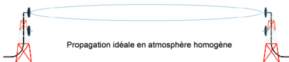
Figure 8 : Propagation idéale d'un faisceau hertzien
