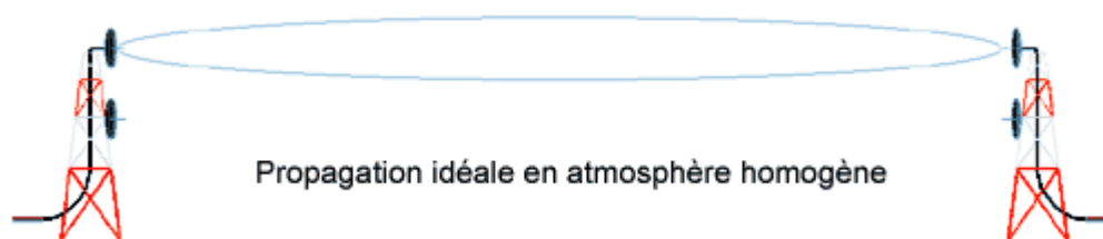
Figure 8 : Propagation idéale d'un faisceau hertzien
