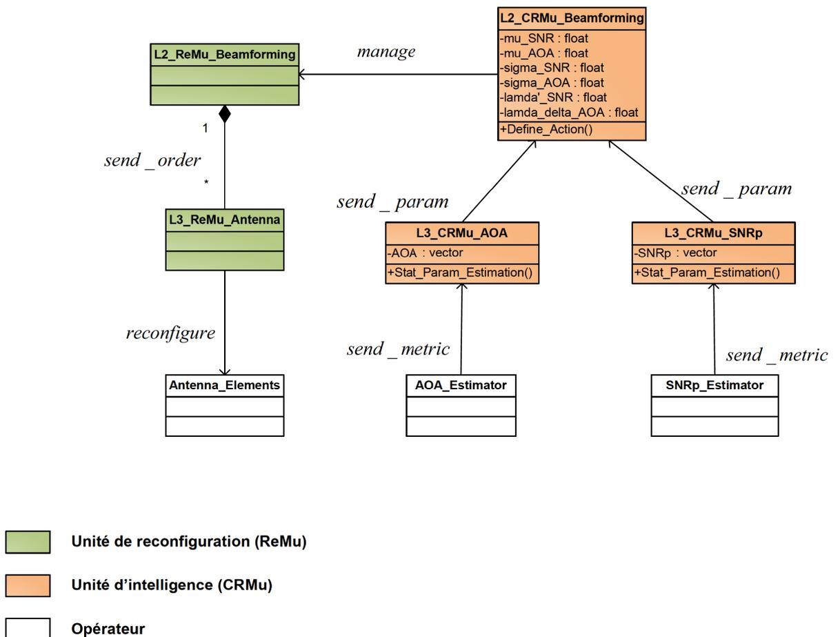
FIGURE 5.16 – Modélisation HDCRAM pour la gestion du beamforming
