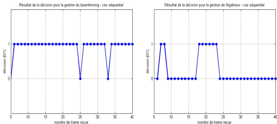
(a) Décisions pour le *beamforming* (b) Décisions pour l'égaliseur après *beamforming*
