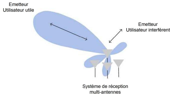
FIGURE 5.1 – Principe du *beamforming* en réception
