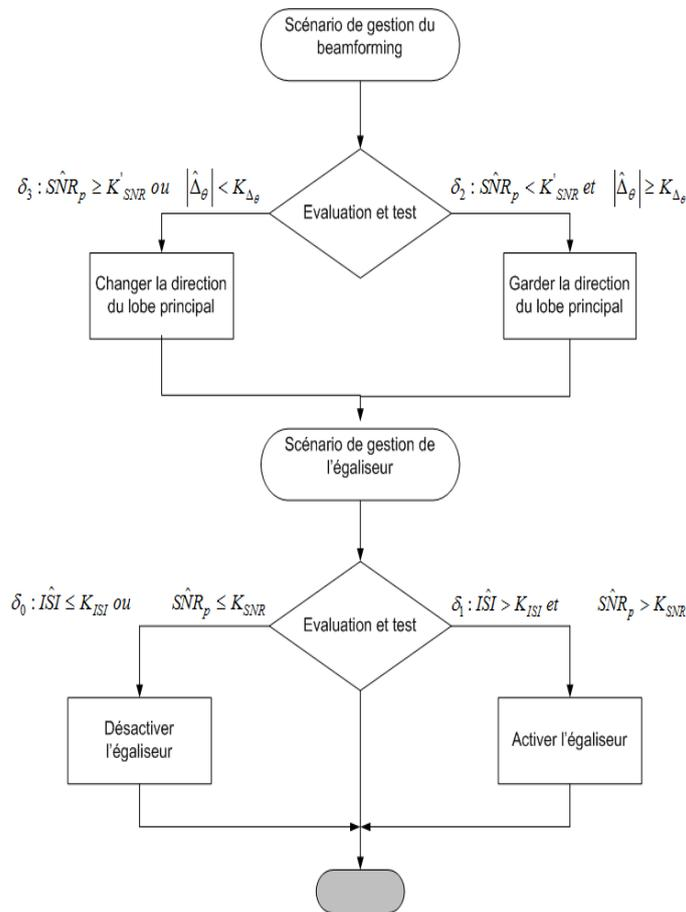
FIGURE 6.3 – Traitement séquentiel des deux scénarios de décision
