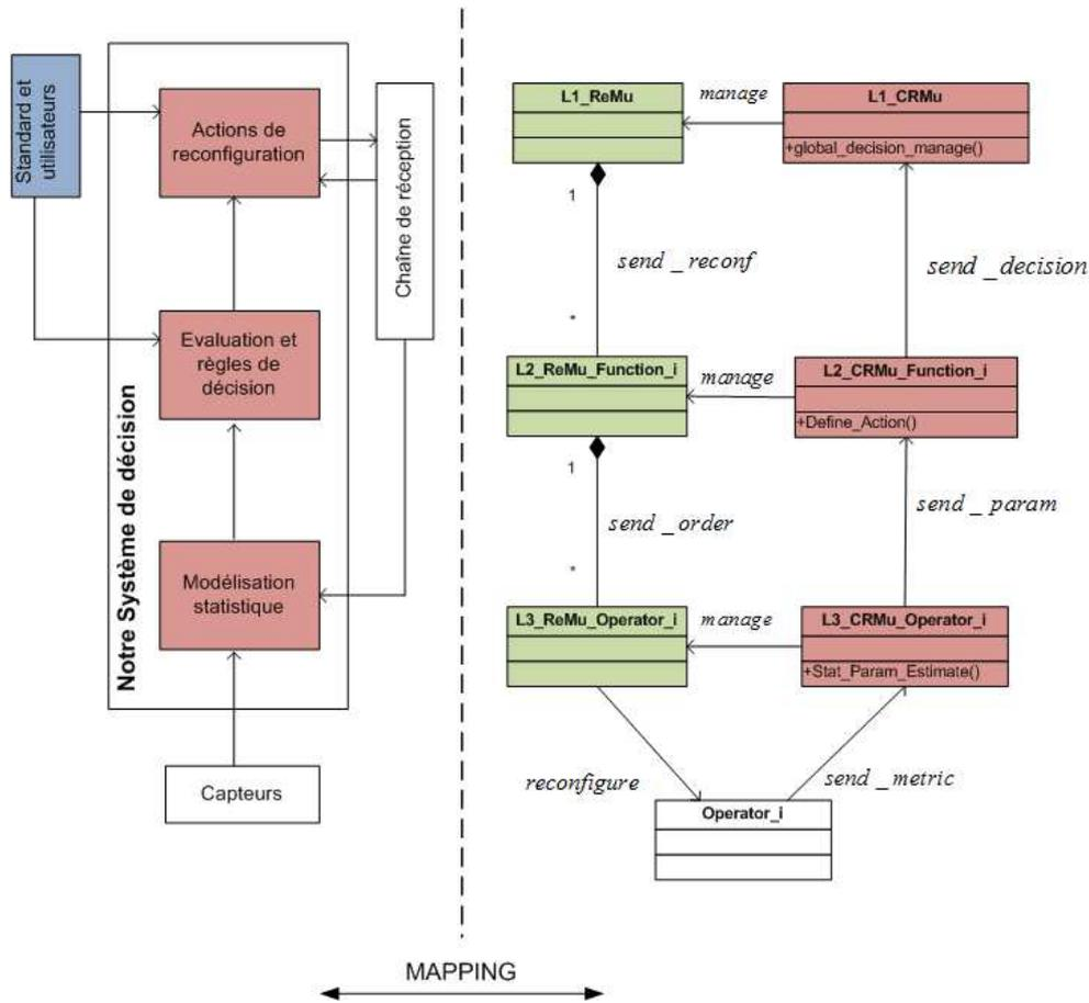
FIGURE 3.10 – Mapping des algorithmes de décision dans HDCRAM
