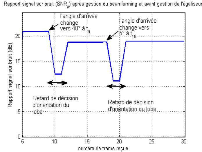
FIGURE 6.6 – Etat du rapport signal sur bruit ( $SNR_p$ ) après gestion du beamforming et avant gestion de l'égaliseur (exemple1)
