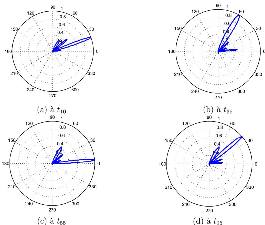
FIGURE 5.14 – Orienter la direction du lobe principal quand la décision est '0' : (a) orienter le lobe vers  $\theta = 20^\circ$  à  $t_{10}$ . - (b) orienter le lobe vers  $\theta = 60^\circ$  à  $t_{35}$ . - (c) orienter le lobe vers  $\theta = 0^\circ$  à  $t_{55}$ . - (d) orienter le lobe vers  $\theta = 40^\circ$  à  $t_{95}$
