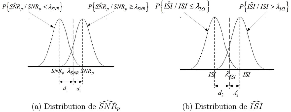
FIGURE 4.6 -  $\widehat{SNR}_p$  et  $\widehat{ISI}$  sont des variables aléatoires gaussiennes de moyennes qui tendent vers  $SNR_p$  et  $ISI$ , et de variances  $(\widehat{\sigma}_{SNR_p}^{ML})^2/n$  et  $(\widehat{\sigma}_{ISI}^{ML})^2/n$ .
