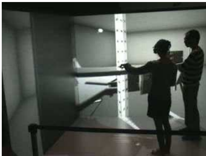
(b) Vérifications de hauteurs avant la mise en fabrication du prototype physique
