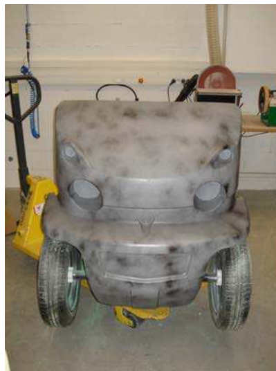
(c) Maquette physique à l'échelle 1 de l'avant du véhicule
