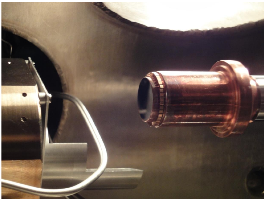
Figure III. 8 Photocathode avec dépôt de \text{Cs}_2\text{Te} dans la chambre de préparation.
