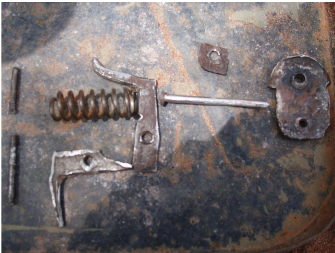
Photo 18 : Détails du mécanisme de percussion
