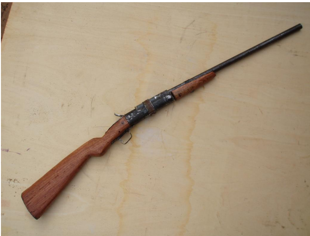
Photo 3 : Le ganapointe, avec son verrouillage à collier
