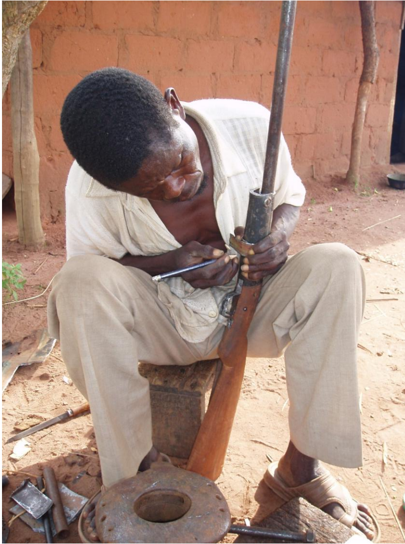
Photo 20 : L'usinage de la bague de serrage
