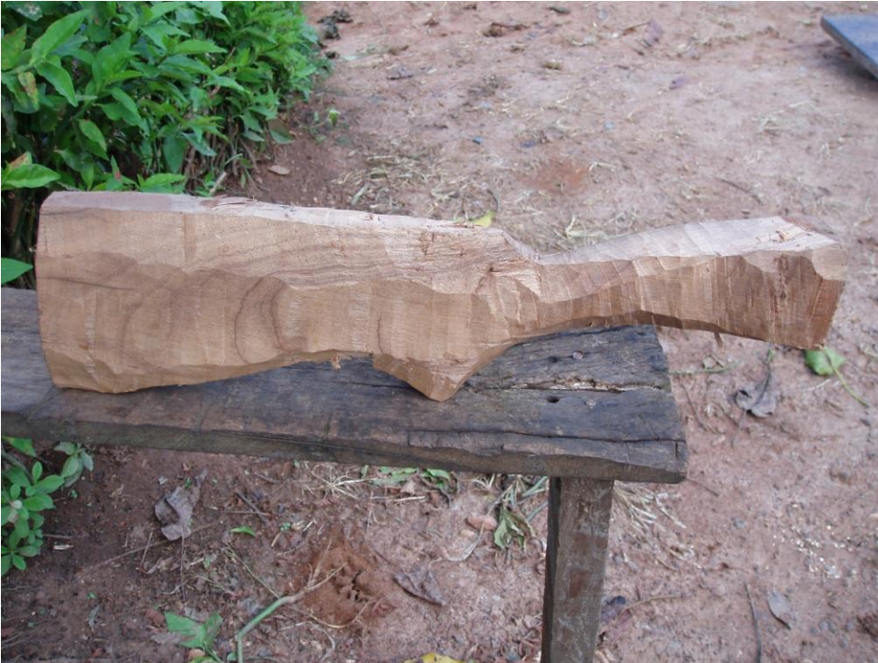
Photo 8 : La fabrication de la crosse
