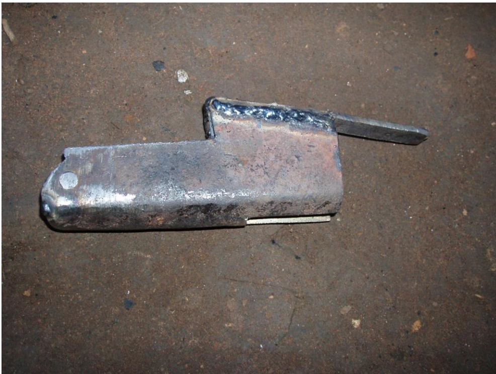
Photo 7 : Le bloc culasse soudé
