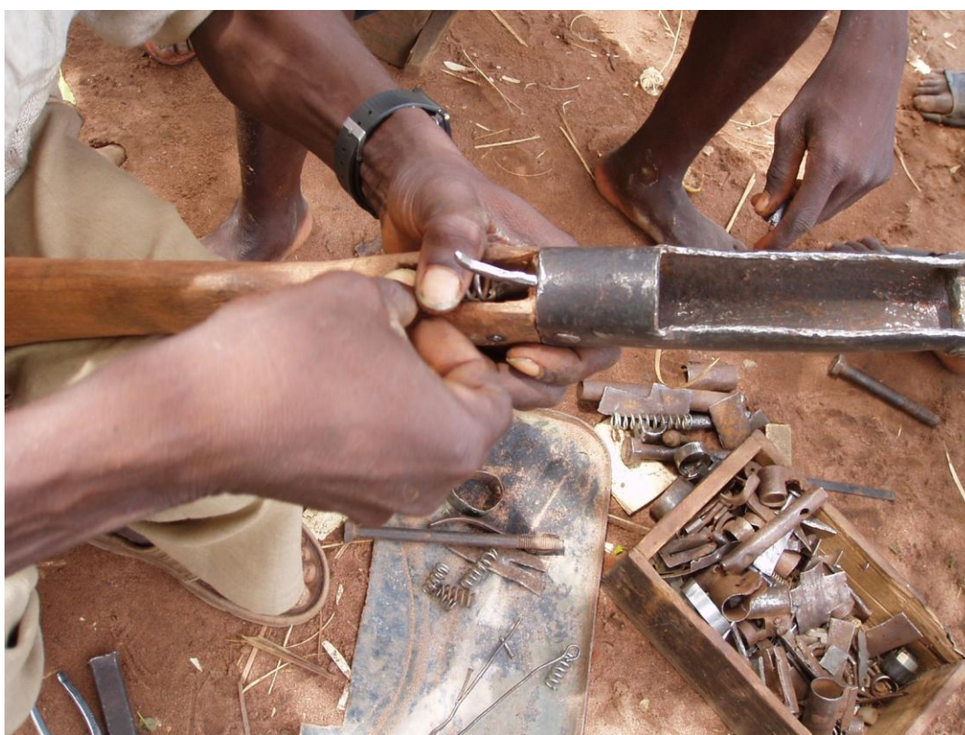
Photo 17 : Le montage du mécanisme de percussion
