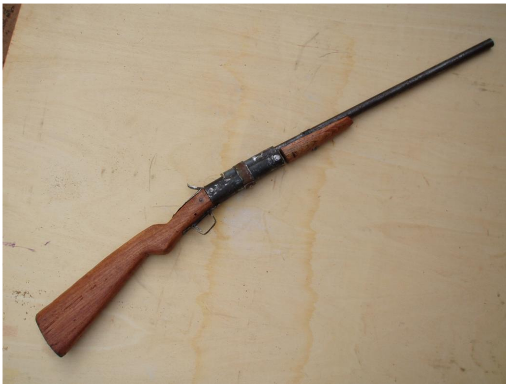
Photo 3 : Le ganapointe, avec son verrouillage à collier
