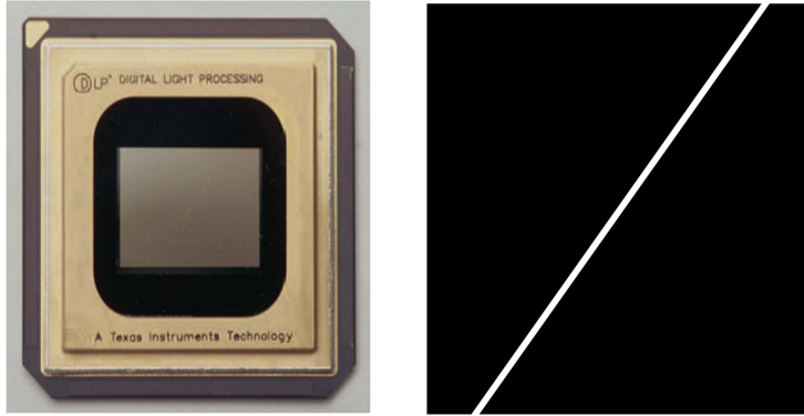
FIGURE 3.16 – Photographie de la matrice de micromiroirs et un masque projeté par cette matrice permettant de garder une seule fréquence du spectre laser.
