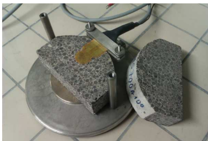
Figure II-15 : Échantillon « prismatique » 14×7×4 cm avec la sonde Hot disk
