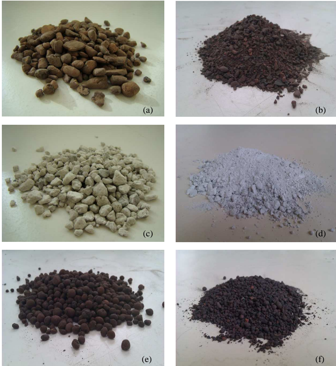
Figure II-1 : Aspects des gravillons légers (a, c, e) et des granulats fins (b, d, f) de schiste expansé, de pierre ponce et d'argile expansée
