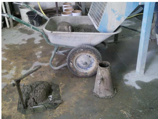
Figure II-11 : a) Contrôle de l'affaissement du béton frais. b) Mesure de la teneur en air du béton frais
