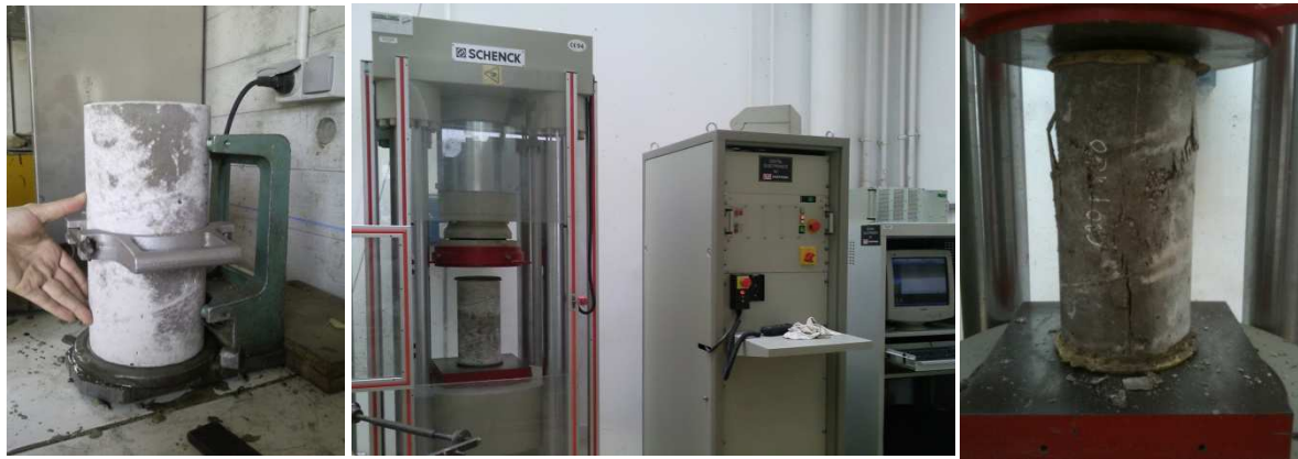
Figure II-13 : a) Surfaçage de l'éprouvette. b) Pilotage de la presse hydraulique. c) Rupture de l'éprouvette du béton de granulat 680P
