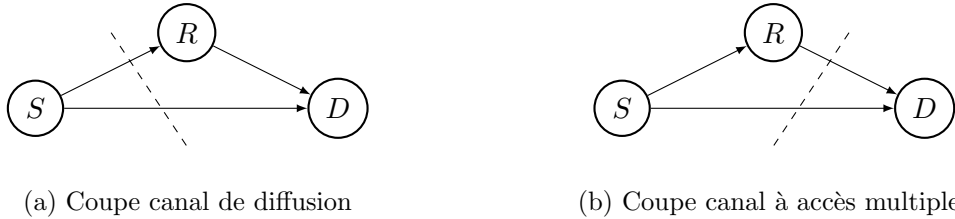
FIGURE 2.7 – Coupes utilisées pour la méthode du flot maximum appliquée au canal à relais.
