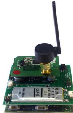
FIGURE 4: Photo de la plate-forme PowWow avec trois cartes: calcul, récupération d'énergie et radio
