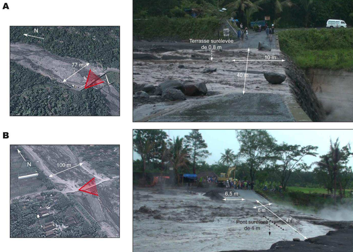
Figure 23 - Exemples de prises de vue pour l'analyse vidéo des lahars. A : site de Kemiri, Boyong. B : site de Plumbon, Gendol. Le champ de vision de la caméra est symbolisé par un triangle rouge sur les vues aériennes des corridors de lahars (images GoogleEarth, 2011). Le déplacement d'éléments flottés (débris végétaux notamment) sur les ponts dont la largeur est connue permet d'estimer la vitesse.
