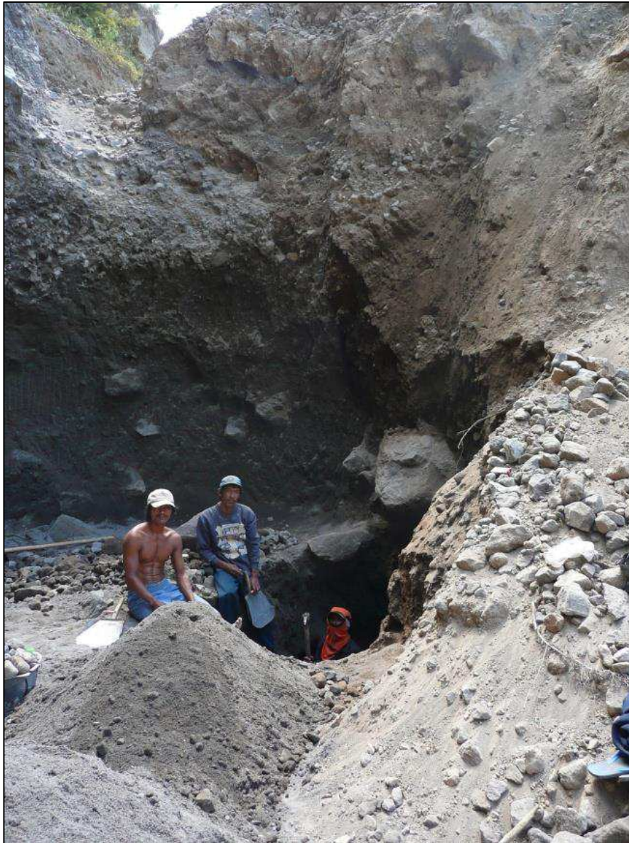
Figure 123 - Une carrière dans le site d'extraction de Jambu-Kaliadem, Gendol. Le trou est profond de 1,8 m pour un diamètre de 3 m (cliché E. de Bézilal, août 2009). Le sable grossier qui sera vendu est amassé en tas avant d'être chargé, visible ici au premier plan de l'image, devant les travailleurs.
