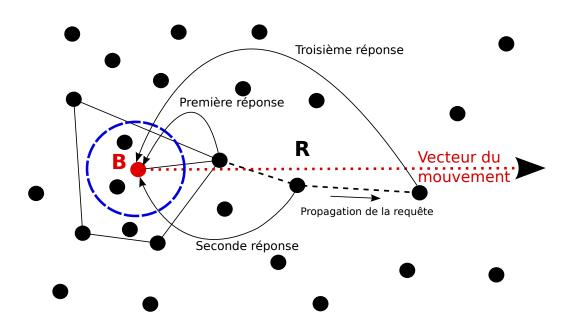
FIGURE 11.2 – Algorithme de préchargement de voisinage : sont concernés les pairs situés le long de la trajectoire supposée de l'avatar.
