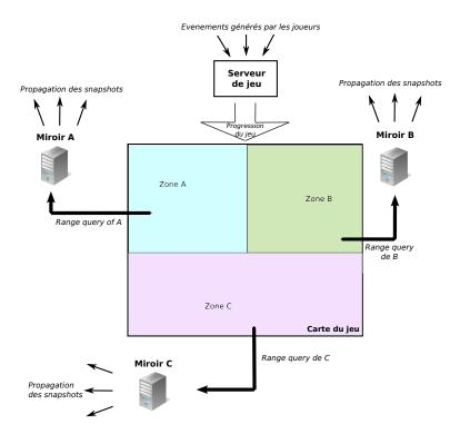
FIGURE 11.4 – Vue d'ensemble de l'architecture de QuakeVolt partitionnant le jeu.
