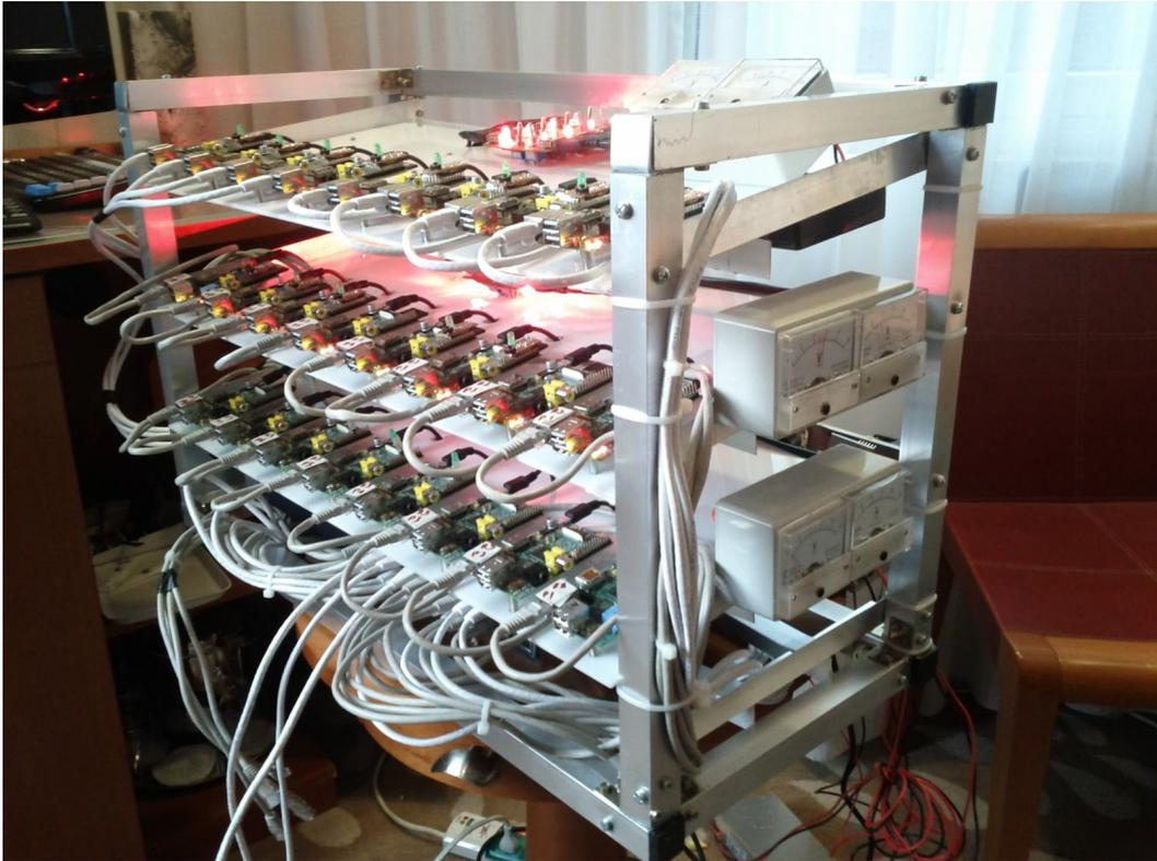
FIGURE 5.2 : Une grappe réalisée avec des RASPBERRY PI.
