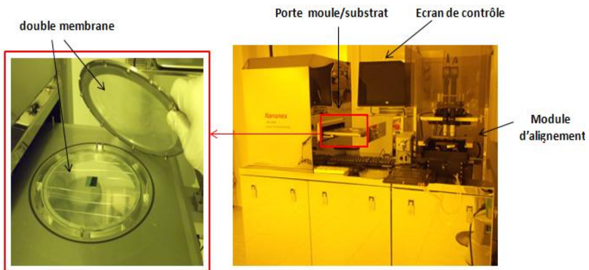
Figure 1.13 : Photographies de la machine d'impression Nanonex NX-2500 installée en zone nanoimpression de la salle blanche du LAAS.
