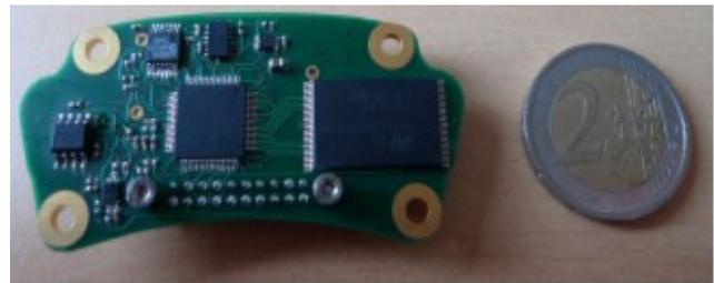
(b) circuits d'instrumentation et d'enregistrement
