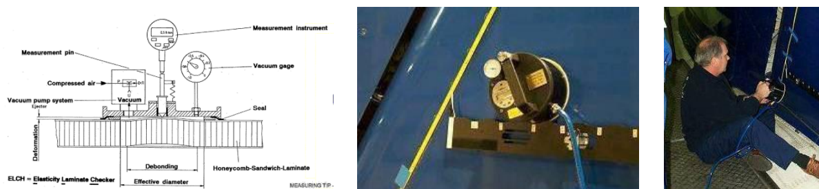
Figure 28 : Technique d'inspection ELCH : mesure d'élasticité [44]
