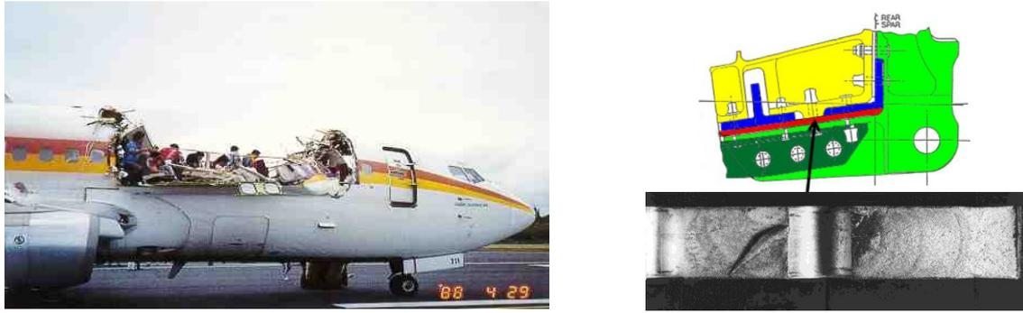
**Figure 20 :** Photo d'un avion ayant subi une perte de 35m<sup>2</sup> de fuselage en plein vol.
