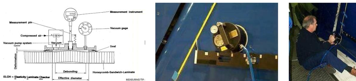
**Figure 28** : Technique d'inspection ELCH : mesure d'élasticité [44]
