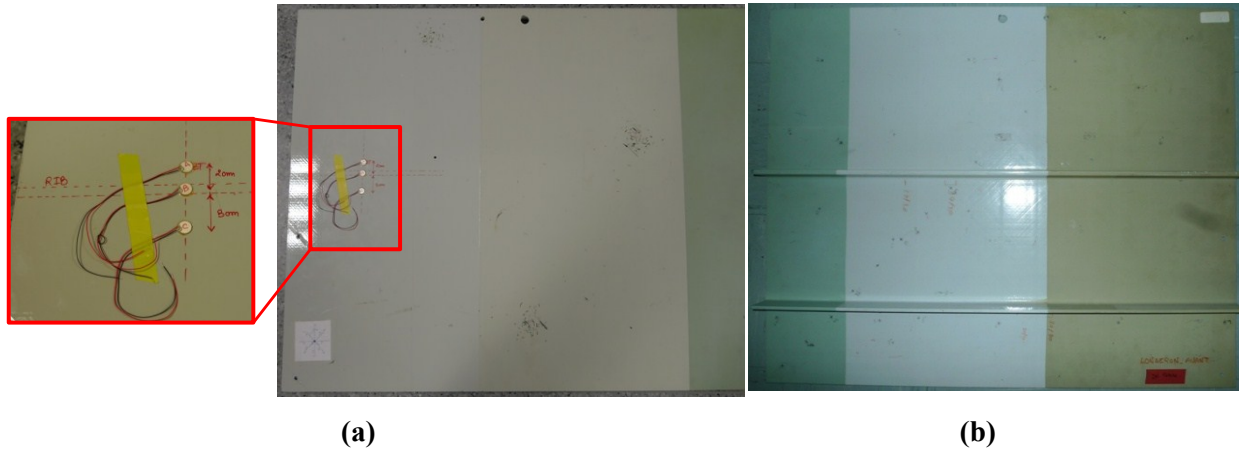
Figure 139 : Eprouvette en composite (a) Vue du dessus : effecteur PZT A à 2 cm du raidisseur, PZT B au dessus du raidisseur et PZT C à 3cm du raidisseur. (b) Vue du dessous du spécimen étudié.
