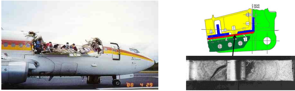
Figure 20 : Photo d'un avion ayant subi une perte de 35m 2 de fuselage en plein vol.
