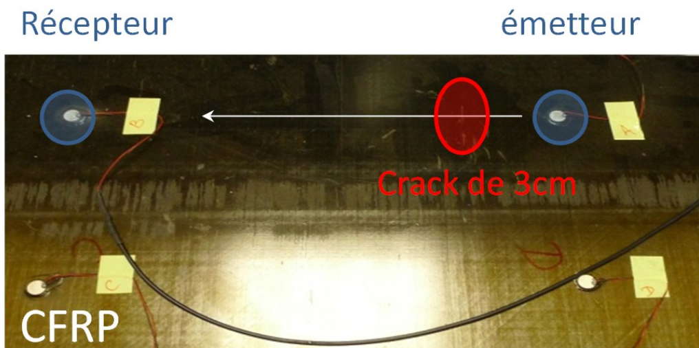
Figure 60 : Photo d'une structure simple comportant un crack de 3cm entre l'émetteur et le récepteur montés en pitch-catch.
