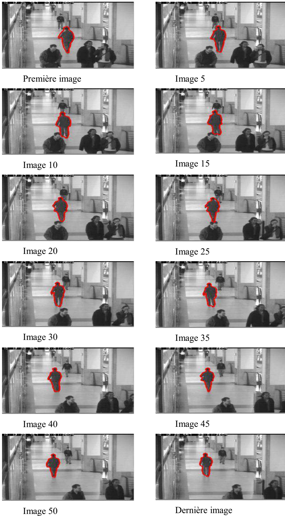
Fig. 6.4 - Suivi d'objet pour le cas de la présence d'autres objets mobiles dans la scène en utilisant l'approche HRIP-AC
