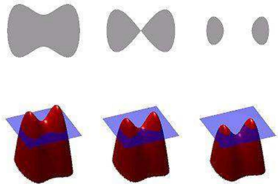
**Fig. 3.5 - Illustration de la méthode des ensembles de niveaux pour la gestion de topologie. La première ligne représente les surfaces correspondantes à la carte des distances illustrées sur la deuxième ligne**
