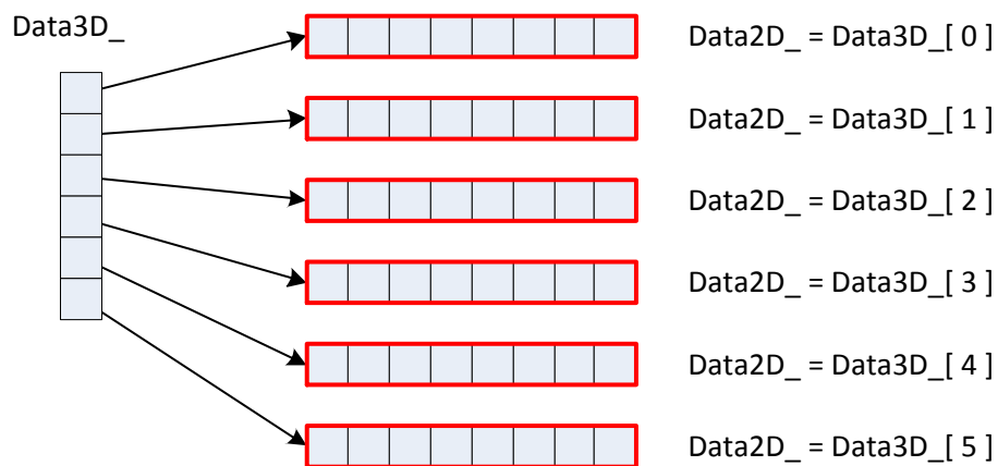
Figure 5-9 : Ancienne représentation de la mémoire d'une instance de Array3D ( x=2 , y=4 et z = 6 ).
