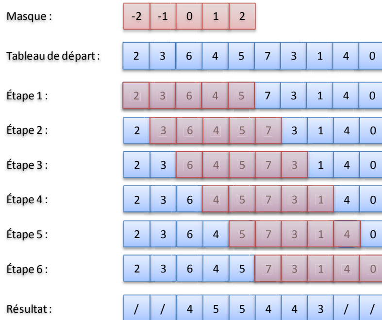
Figure 3-4 : Exemple de l'application d'un filtre moyenneur sur un tableau de 10 entrées.
