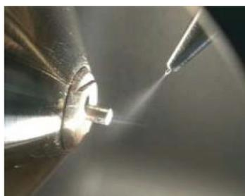
Figure II.3 Photographie d'une source électrospray (Thermo)
