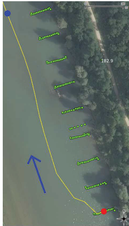
FIGURE 5.28 – Comparaison des positions d’un PIT-Tag avant (rond rouge) et après la crue de 2010 (rond bleu) avec les lignes de courant simulées (courbe jaune). La flèche bleue indique le sens de l’écoulement et les points verts les positions des 1 500 PIT-Tags avant la crue. Les paramètres de la simulation 2D sont indiqués à la Figure 5.25
