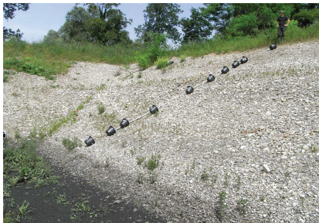
FIGURE D.1 – Position des prélèvements granulométriques sur le talus du décaissement de la section II au pk 182,200 (Source : Regina Ostermann - RPF)
