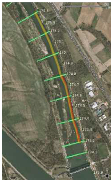
FIGURE 6.2 – Photographie aérienne du site Kembs et localisation des bancs longitudinaux fictifs, avec en orange le banc d'environ 60\,000 m 3 qui aurait une largeur au sommet de 15 m et en rouge le banc d'environ 20\,000 m 3 , d'une largeur de 11 m. La hauteur de ces deux bancs mesurerait de 2 à 3 m. Les traits verts localisent les sections en travers du maillage utilisé dans les simulations 1D
