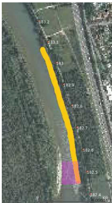
FIGURE 6.1 – Photographie aérienne du site InterReg et localisation schématique du banc longitudinal (orange) et du banc fictif transversal (violet). Le banc longitudinal a une largeur au sommet d'environ 11 m et s'étend à proximité de la rive droite du PK 182,460 au PK 183,080. Le banc transversal serait présent sur toute la largeur du lit et distant d'environ 1 à 2 m des berges gauche et droite respectivement. Ce banc fictif irait du PK 182,460 au PK 182,561
