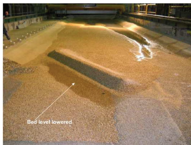
FIGURE 1.14 – Photographie du scénario 5 sur le site O2 qui consiste à enlever les protections de berge et abaisser la cote du fond en amont de l'épi (Source : Kamal El Kadi Abderrezzak - EDF)
