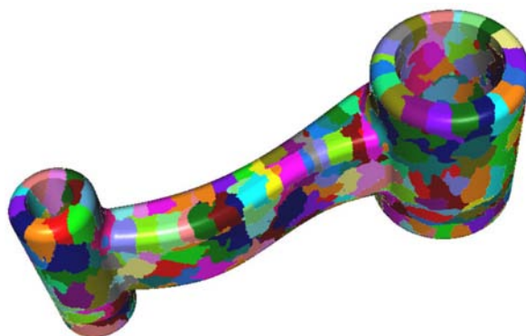
FIGURE 5.27 – Coupe du maillage isotrope d’une biellette, sur lequel a été testé la méthode d’identification des zones par partitionnement.
