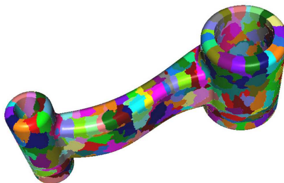
FIGURE 5.27 – Coupe du maillage isotrope d'une bielle, sur lequel a été testé la méthode d'identification des zones par partitionnement.
