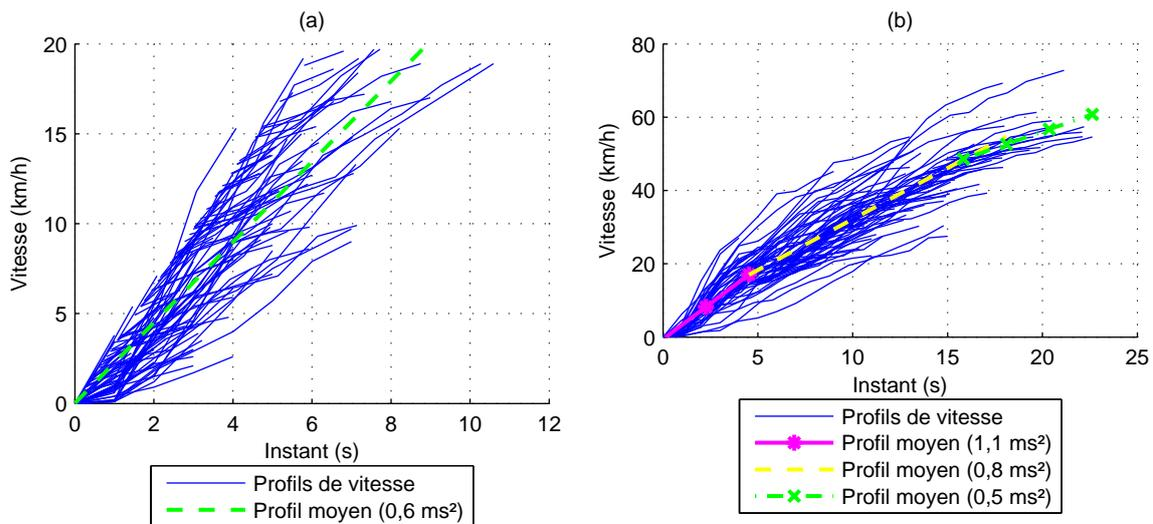
FIGURE 3.5 – Les profils d'accélération des sous-cycles réels regroupés.
