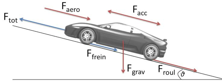
FIGURE 2.2 – Schéma des forces appliquées au véhicule.
