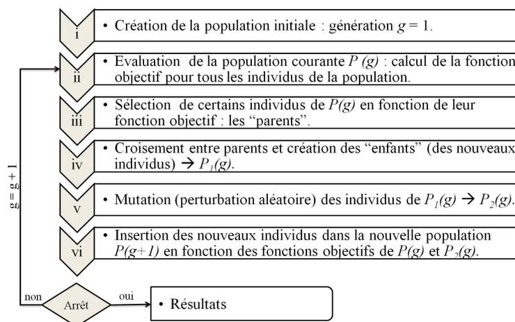
FIGURE 3.3 – Schéma général d'un algorithme génétique.
