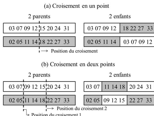
FIGURE 3.4 – Schémas illustrant (a) un croisement en un point et (a) un croisement en deux points. Les positions marquées correspondent au locus ou emplacement sur le chromosome où l’enjambement se réalise.
