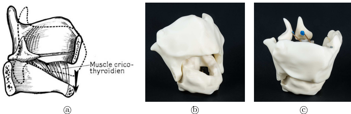
FIGURE 1.5 – Articulatio crico-thyroïdienne. (a) d'après [LPV88]. (b)-(c) démonstration sur une maquette robotisée à l'échelle 5 :1. L'amplitude de rotation a été ici volontairement exagérée pour illustrer l'articulation.
