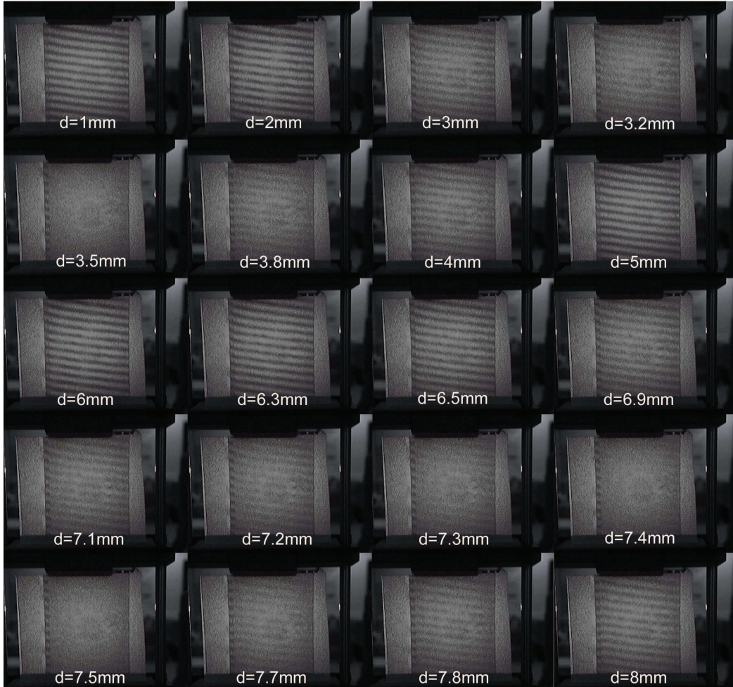
FIGURE 16.5 – Influence de la distance inter-réseaux sur les franges de moiré. d est la distance relative entre G1 et sa position initiale.
