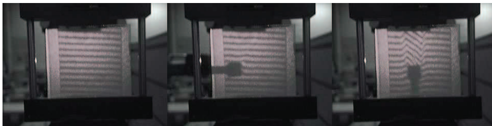
FIGURE 16.7 – Vignette gauche : défectogramme de référence. Vignette droite : défectogramme avec la torche butane/air à la verticale. Les franges sont fortement perturbées, preuve de forts gradients d'indice orientés selon x . Vignette centrale : défectogramme avec la torche à l'horizontale, aucun gradient d'indice orienté selon y n'est visible.
