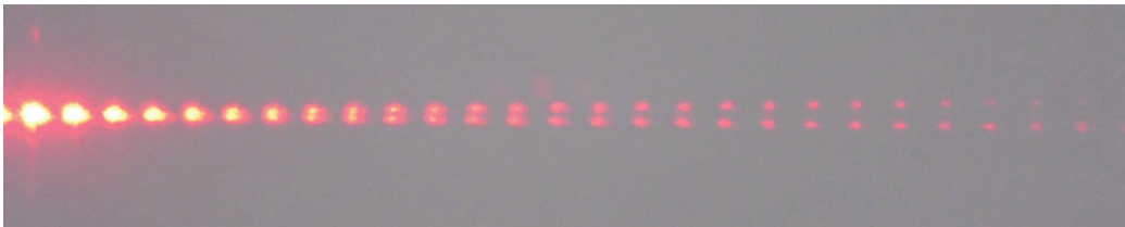
FIGURE 16.4 – Transformée de Fourier du signal en sortie de déflectomètre. L'angle de rotation des réseaux est obtenue grâce aux points lumineux en diagonale qui sont les termes correspondant à G1 et G2 .
