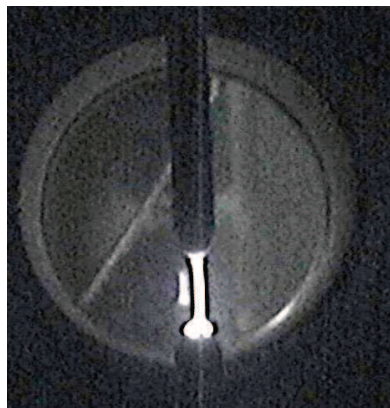
FIGURE 17.2 – Photographie de la décharge prise avec un temps de pose de 1/100 de seconde. La colonne de plasma est quasi-cylindrique et possède un rayon de 0.8 mm.
