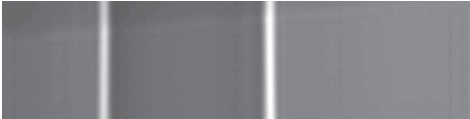
FIGURE 15.11 – Shadowgramme enregistré sur un jet de plasma laminaire d'argon.
