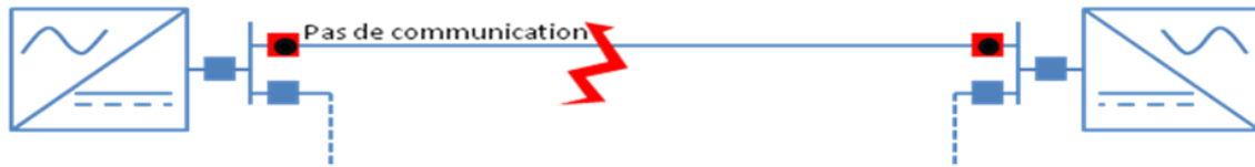
Figure 6.12: Protection différentielle de tension
