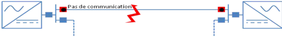
Figure 6.12: Protection différentielle de tension
