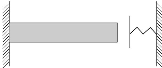
FIGURE 3.15 – Barre en traction/compression avec une condition au limite de contact unilatéral.
