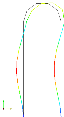
FIGURE 4.8 – Déformée issue de la famille de solutions périodiques du premier MNL en flexion hors-plan ( E = 0,0746 J, f = 6,0729 Hz). Mouvement purement dans le plan.
