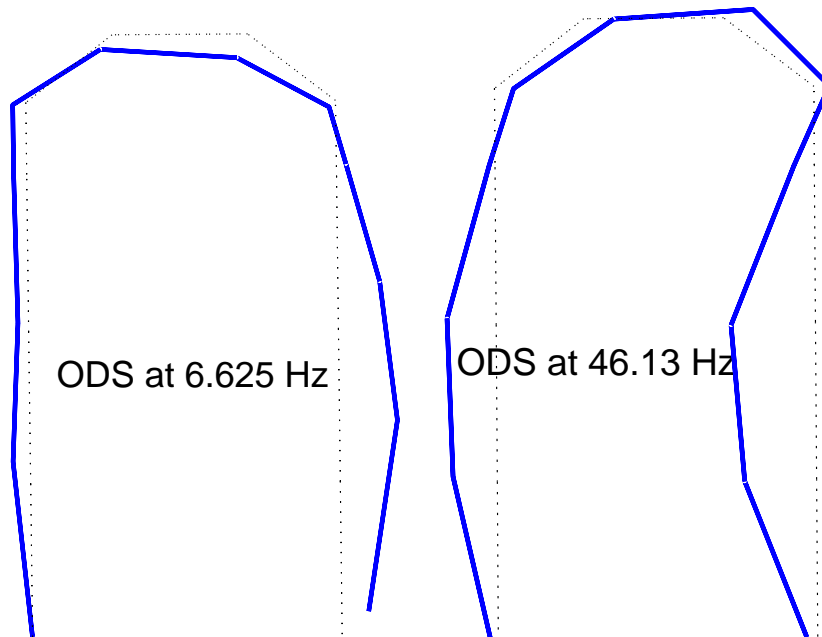
FIGURE 4.14 – Déformées en fonctionnement (ODS) au voisinage de t = 260 s à la fréquence f = 6.625 Hz (à gauche) et pour la septième harmonique, f = 46.13 Hz (à droite).
