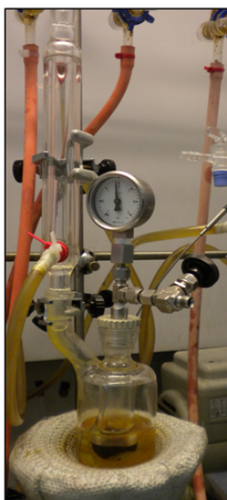
Figure III.59 – Montage du réacteur Fisher-Porter utilisé
