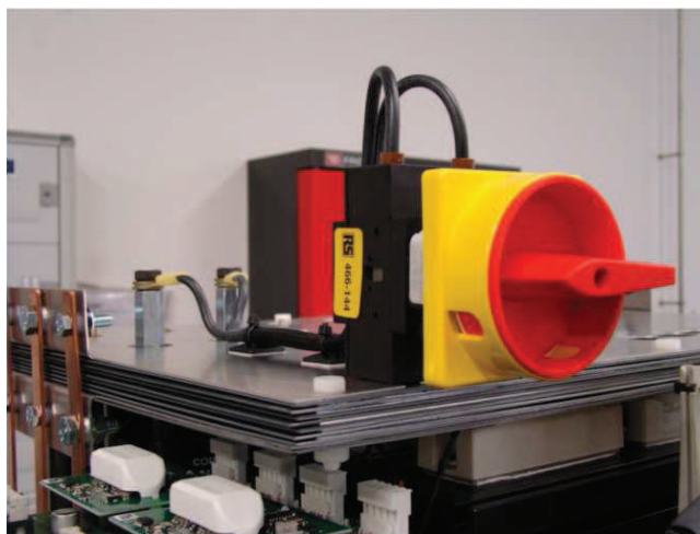
FIGURE 4.9 – Système de court-circuit pour passer de 4 à 3 cellules.
