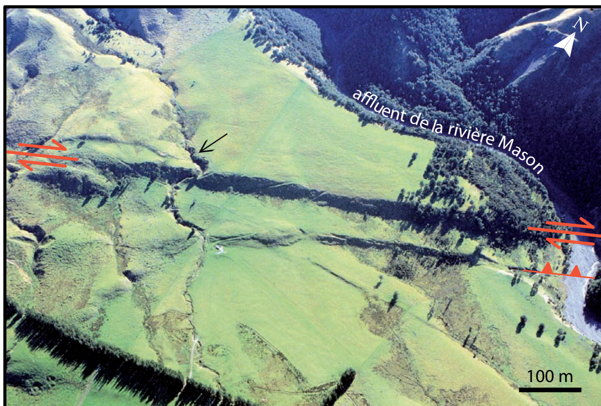
FIGURE 3.2 – Photo aérienne oblique du site de Terako [d'après Eusden et al., 2000]. Les escarpements des deux traces principales de la faille Hope coupent les terrasses alluviales qui descendent vers la rivière Mason à l'est. La végétation masque les bords de terrasse les plus récents situés à proximité de la rivière. La branche nord de la faille décale latéralement le ruisseau indiqué par la flèche noire. Ce ruisseau borde la zone d'acquisition GPR à l'ouest. A l'est cette zone est limitée par les arbres et les zones marécageuses caractérisées par leur végétation plus sombre.
