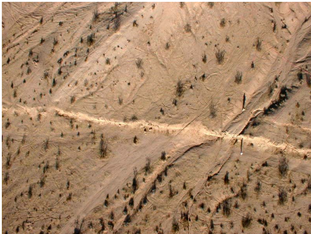
FIGURE 1.4 – Photographie de la rupture en surface produite par le séisme de Landers de magnitude Mw 7.3 en Californie avec un mouvement décrochant dextre [Arrowsmith and Rhodes, 1994].
