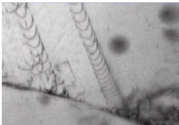
Figure II. 33 : Empilement de dislocations à l'origine de ces bandes de glissement, observées sous MET in situ
