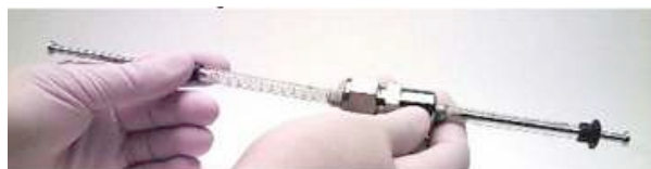
FIGURE 3.16 – Image d’un extrudeur. Le filtre de polycarbonate est placé entre les deux seringues.
