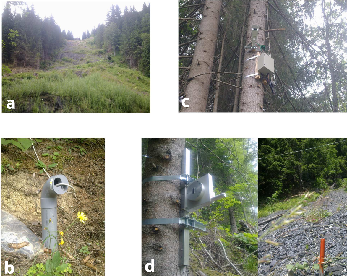
FIGURE 9.1 – Photos des nouvelles installations. a) Vue dégagée du bas du glissement après par le glissement-coulée de 2010. b) Une des huit buses en plastique accueillant un nouveau capteur d'écoute passif à composante verticale. c) Caméra installée en bas du glissement pour une surveillance visuelle en continu. d) Installation d'un des deux extensomètres.
