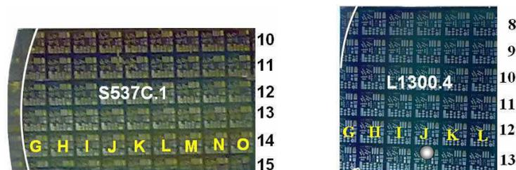
**Figure II-56** : Les échantillons S537C.1, L1300.4. Les lignes blanches indiquent la limite d'épitaxie près du bord des wafers. La dimension de chaque matrice est de  $4*4\text{mm}$ .
