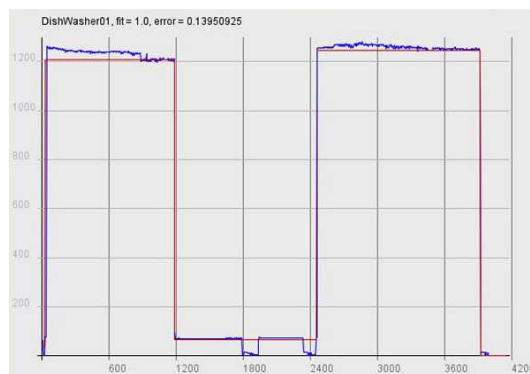
FIGURE 3.9 – Consommation électrique d'un lave vaisselle
