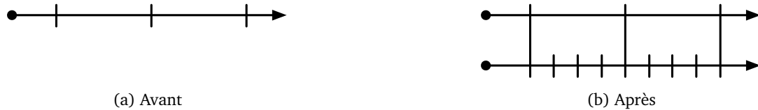
FIGURE 1.2 – Le raffinement temporel avec le sous-échantillonnage (les traits verticaux représentent les instants d’une horloge, les lignes horizontales représentent des processus lancés en parallèle)
