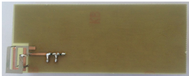
Figure 3.58 Prototype de l'antenne avec deux cellules d'adaptation
