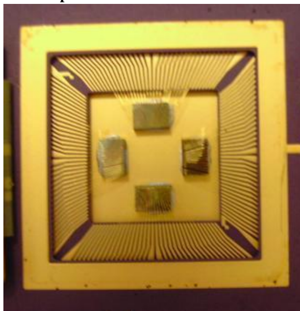
Figure 128 : photographie du démonstrateur comprenant quatre puces
