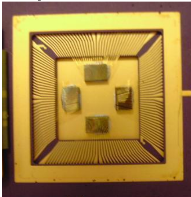
Figure 128 : photographie du démonstrateur comprenant quatre puces
