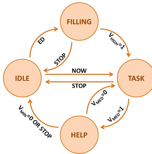
FIGURE 5.9 – Machine à état de gestion d'alimentation d'une sortie en tension
